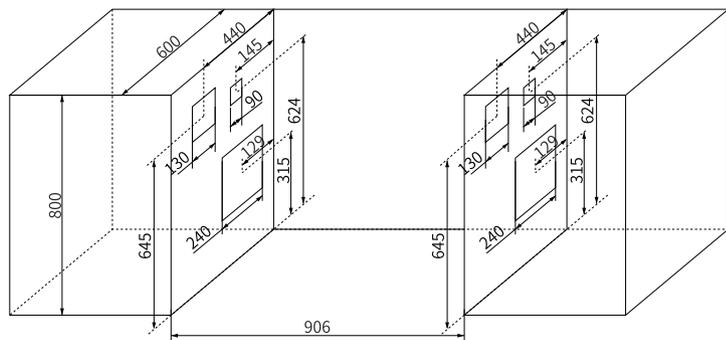
1. 检查机器出风口位置, 确认厨房出风口位置。按安装图要求, 在合适位置开直径185mm的墙孔。
