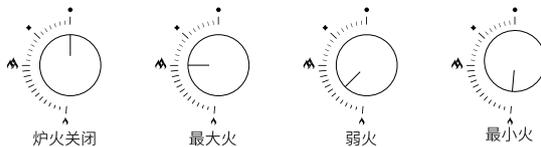
大火指示逆时针转动时, 外圈火逐渐变小直至关闭, 转到小火指示时仅留中心火, 此时火力最小。
